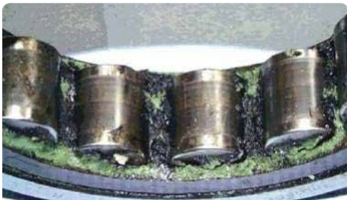
Degradación del lubricante causada por paso de corriente eléctrica
