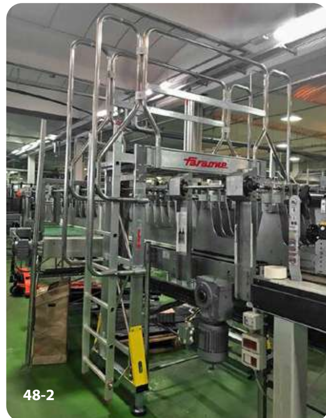
Scala a ponte ad U con doppia salita. U-shaped crossover ladder with dual access.
